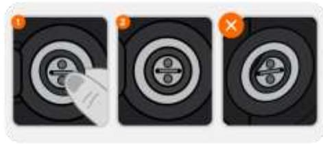
Veiller à ce que le joint d'étanchéité soit bien en place et installé de manière uniforme dans la rainure de la station d'accueil et qu'il ne ressorte pas vers l'extérieur. Mettre au rebut le joint d'étanchéité usagé.
