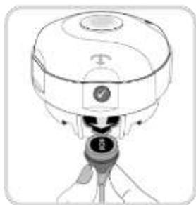
Appuyer une dernière fois ou soulever le capteur et le retirer du changeur de membrane. Le symbole √ indique que le changement de membrane est terminé.
